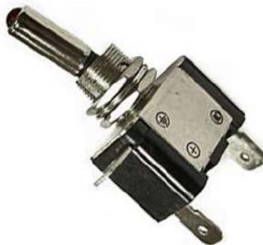
Тумблер двухпозиционный однополюсный ASW-07D SAC- 01, 61,7x16x28 мм. ON-OFF, SPST, 20 A, 12 В, 50 мОм, 3 контакта, под пайку, с красной LED индикацией - это малогабаритный переключатель на два либо три положения с рычажно-пружинным приводом. Применяется главным образом для коммутации цепей управления.
